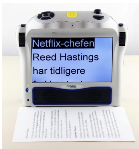
Илл. 37. Портативное электронное устройство, преобразующее текст в речь
