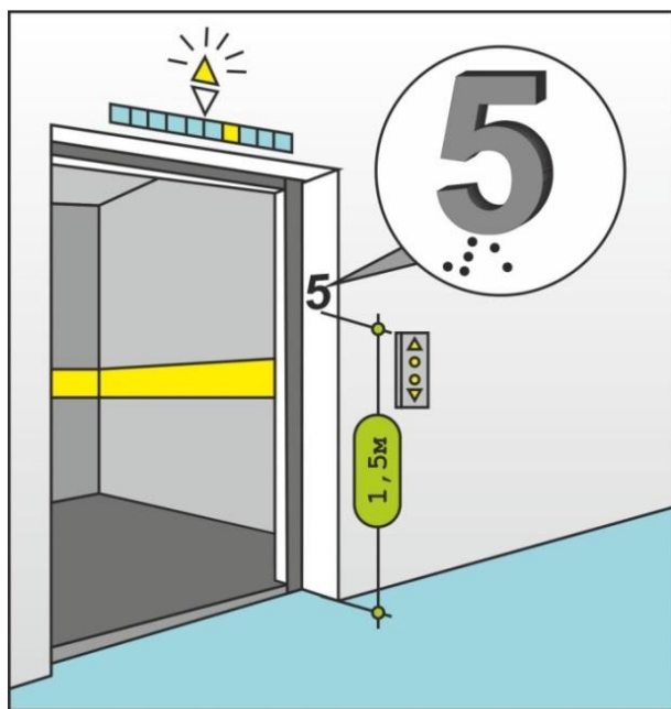
Илл. 2.6-25. Требования к выполнению тактильного указателя этажа
