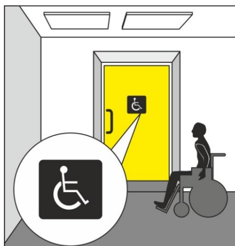
Илл. 2.5-10. Требование к маркировке дверей символом доступности
