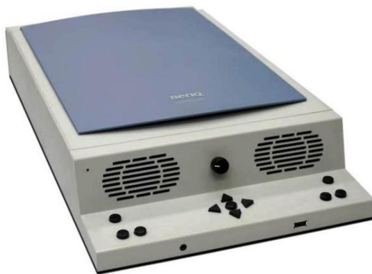
Илл. 38. Аппаратно-программный комплекс «Читающая машина»
