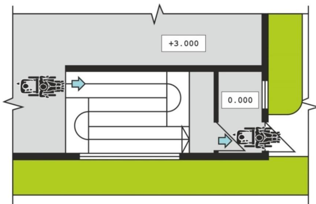
Илл. 2.6-31. Требования к пандусу, служащему путем эвакуации со второго и вышележащих этажей
