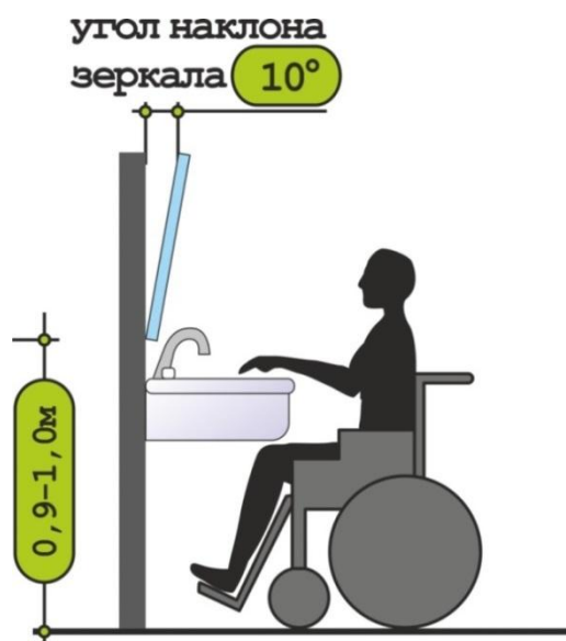
Илл. 2.8-9. Размещение зеркала в универсальной туалетной кабине
